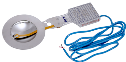
Hälytin voi olla myös integroituna levyyn. Hälytys tapahtuu virtapiirin katkeamisen seurauksena.
